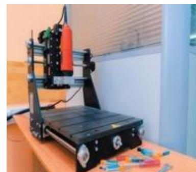
Фрезерно-гравировальный станок с числовым программным управлением.
