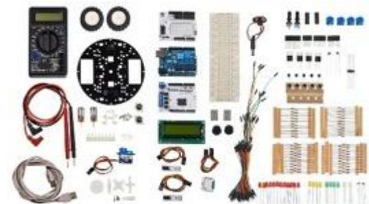
Набор образовательный для пошагового ознакомления с работой на языке C++ и сборки робототехнической модели
